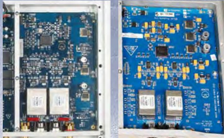
**UNGLEICHE BRÜDER:** Die Platinen der beiden Klimax-Modelle (links das neue, rechts das alte) unterscheiden sich schon auf den ersten Blick recht deutlich. Die Alu-Wand am linken Bildrand trennt den Netzwerkbereich ab, die einteilige Hauptplatine geht aber unter ihr hindurch. Der quadratische Chip im oberen Teil beider Audioboards ist ein FPGA, der hier als programmierbares Digitalfilter dient.
