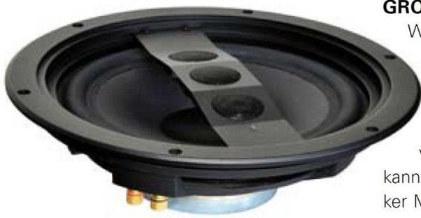
**ELB-BRÜCKE:** Die drei Tweeter sind im Winkel zueinander angeordnet, um die Abstrahlung nicht zu eng werden zu lassen. Die Brücke sitzt koaxial vor dem Tieftöner und bewirkt sowohl Bündelung wie auch eine bessere Trennung der Töner.
