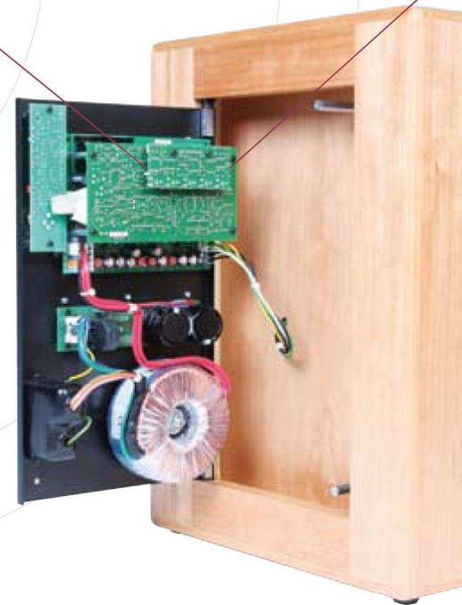
**IM SEPARÉE:** Die akustisch getrennte Verstärkersektion kann man ausklappen – wichtig für den Service und zur Einstellung der fünf Ortsanpassungsfilter (Pfeile).
